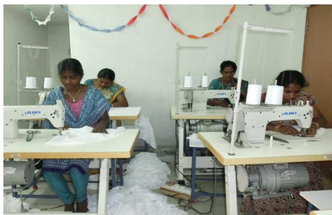
写真上：工業用ミシンでキッチンマットを縫製する女性
