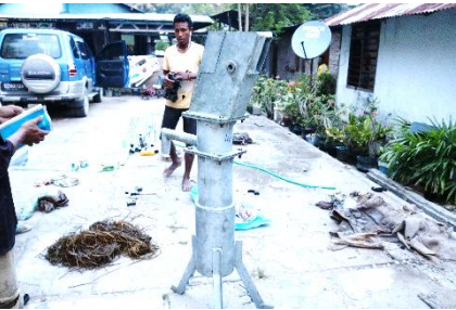
<深井戸用手動ポンプ>
